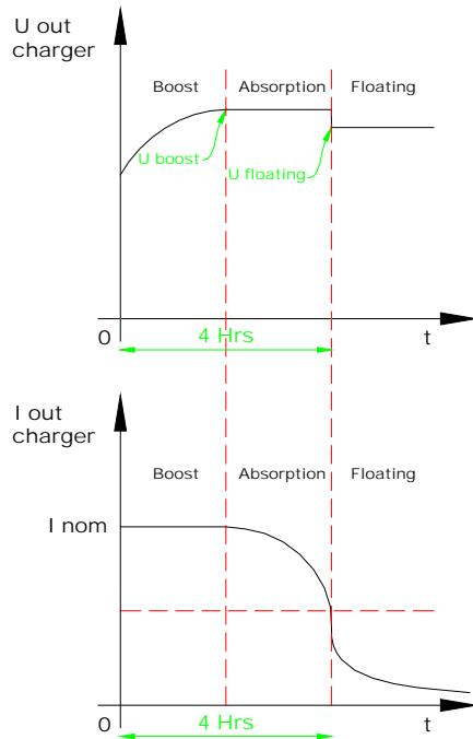
**Fase Boost:** si avvia automaticamente non appena il caricabatteria viene messo sotto tensione e se la batteria è scarica. In questo caso la corrente è al massimo
